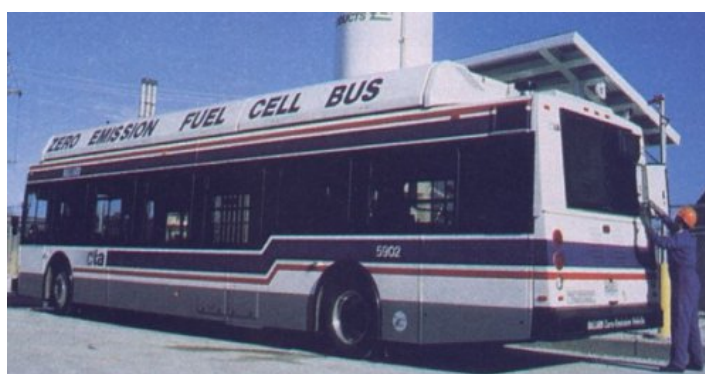
Figure 15 : Bus alimenté par des piles à combustible (hydrogène+air) Source : Technology Environment Data Leap 2000.
